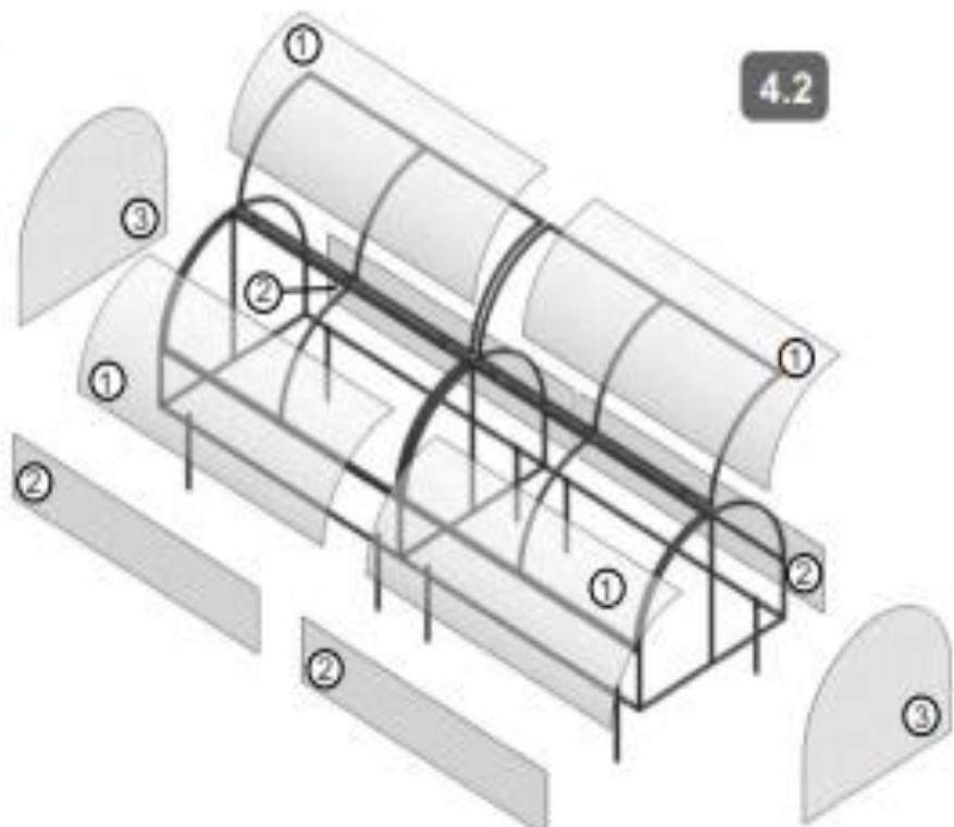
Дет. 2 СПК обшивки по верхней перемычке
