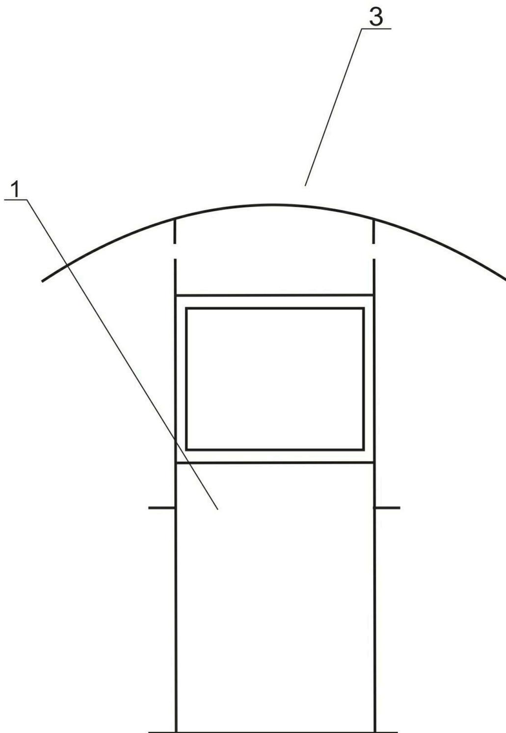
Дуги боковые 2 прикрепляем к дуге верхней 3 при помощи продольного элемента среднего 6. При помощи горизонтального элемента соединения(1м) 4 и продольного элемента нижнего 5 скрепить дуги боковые 2 и рамку двери 1.
